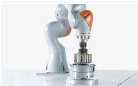
PRÄZISE MONTAGE: Der LBR iiwa erkennt mithilfe seiner Sensorik die korrekte Einbauposition und montiert Teile rasch und gefühlvoll.
