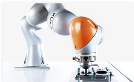
STOPFEN SETZEN: Bei der Montage flexibler Automobilteile erfüllt der LBR iiwa unergonomische, monotone Aufgaben höchst zuverlässig.
